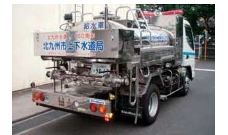
給水車(加圧式)
