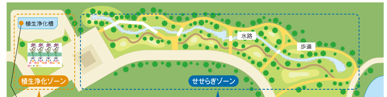
植生浄化槽(長さ 30m、幅 8m)
