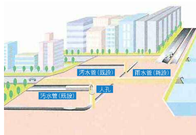
今まで一つの下水管で処理していた雨水と汚水を、雨水管を新設してふたつに分けて処理することによって、公共水域に汚水が流出する心配がなくなる。
